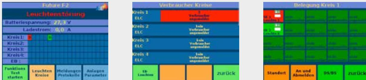
Bei der Einzelleuchtenüberwachung werden Leuchtenfehler als rotes Feld angezeigt und „Leuchtenstörung“ erscheint im Startmenü.
