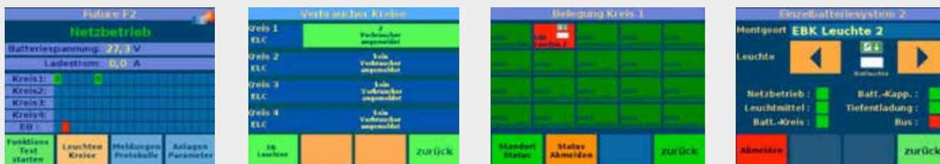
Die Zentrale überprüft in der Statusanzeige ständig die ordnungsgemäße Ladung der Batterien <5min und die Funktion der Leuchte bei einem automatischen oder manuellen Funktionstest.
