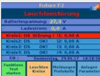
Bei der Kreisüberwachung werden Kreisfehler als rotes Feld angezeigt und „Leuchtenstörung“ erscheint im Startmenü.
