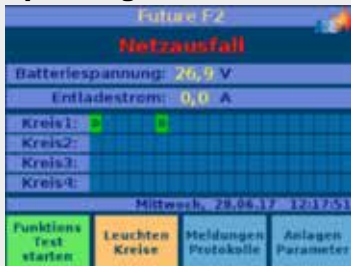
Netzausfall Einspeisung > Umschaltung auf Batterie
