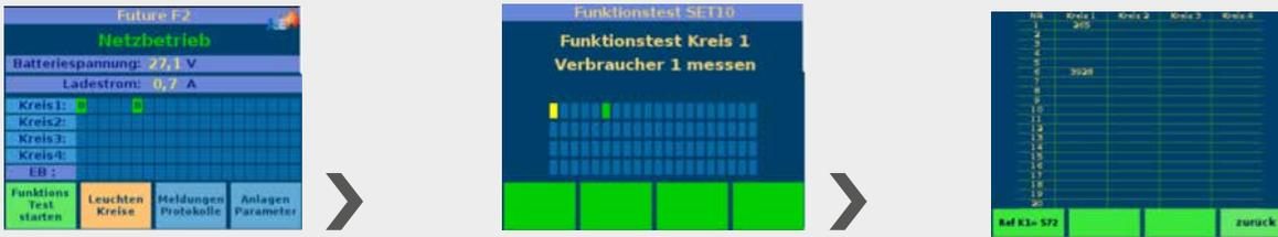
Entsprechend den aktuellen Vorschriften muss mindestens ein wöchentlicher Funktionstest durchgeführt werden. Ist das Gerät autark, muss der automatische Funktionstest aktiviert und die Testzeit eingestellt werden.
