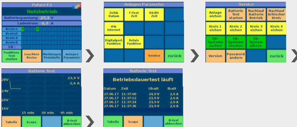
Entsprechend den aktuellen Vorschriften muss mindestens einmal jährlich ein Batterietest bzw. Betriebsdauertest durchgeführt werden. Eine automatische Durchführung ist nach den aktuellen Normen nicht vorgesehen, da ein unbeaufsichtigter Batterietest fatale Folgen haben könnte.
