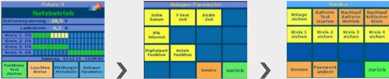
Werden Leuchten nachträglich eingefügt oder entfernt, muss der entsprechende Kreis neu geeicht werden. Bei der Stromkreisüberwachung wird der neue Stromwert ermittelt, bei der Einzelleuchtenüberwachung die aktuell erkannten Leuchten.
