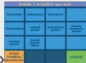
Den digitalen Ausgängen 1+2 können verschiedene Funktionen zugeordnet werden. Diese werden parallel zu den Relaisausgängen „Netz/Batt“ und „Gut/Stör“ an den Klemmen „Fernbedientableau“ 1-4 ausgegeben. Zusätzlich wird über „Gnd“ (Ground/Masse) und „BS/DS“ der Schlüsselschalter angeschlossen.
