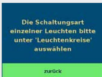
Diese kann durch die Software überschrieben werden, jede Leuchte kann einzeln konfiguriert werden. Dabei muss der Kreis immer auf Dauerschaltung (DS) programmiert sein.
